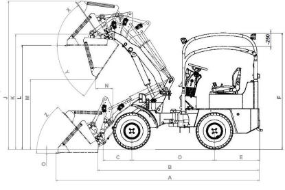
Indications sans contre-poids arrière Dimensions avec pneus standard
