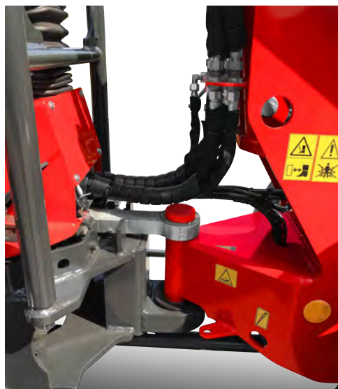
Robustes, wartungsarmes Knickpendelgelenk
