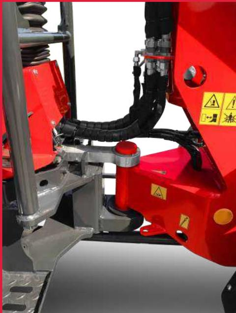
**Sur toutes nos machines l'articulation centrale pivotante est une construction très robuste nécessitant très peu d'entretien.**
