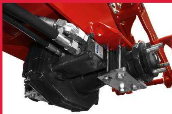
**La pompe hydrostatique alimente les moteurs hydrauliques**
