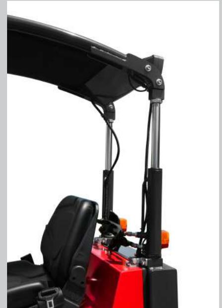
**La cage de protection ROPS-FOPS réglable en hauteur par voie hydraulique a été brevetée et récompensée par plusieurs prix d'innovation. Vous pouvez abaisser sa hauteur de 25 cm. Cela permet de franchir des portes ou autres obstacles inférieurs à 2 m.**
