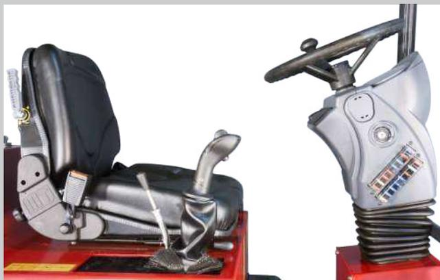
**Joystick multifonction à mono-levier et colonne de direction multifonctions réglable**
