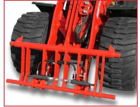
**Les outils et accessoires pour le système d'attelage de tube rectangulaire Thaler original sont compatibles avec le système actuel à crochet Thaler.**
