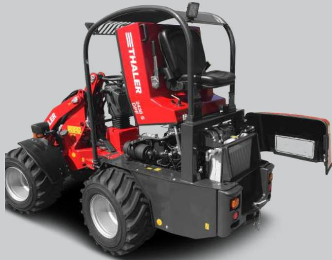
**Maintenance, révision et service faciles et rapides à réaliser. Avec seulement un minimum de manipulation, tous les principaux points de service sont accessibles.**
