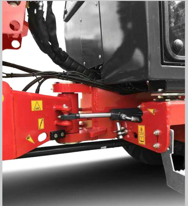
Direction par articulation centrale: stable et fiable, réalisé avec 2 vérins hydrauliques
