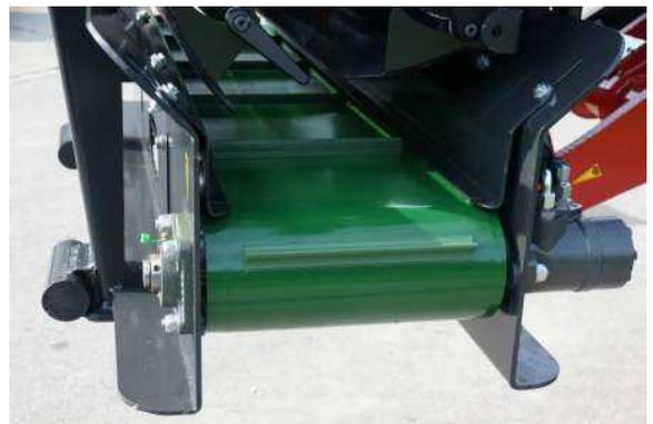
Ses besoins en huile hydraulique : de 40 L/min à 60 L/min @ 180 bar!
